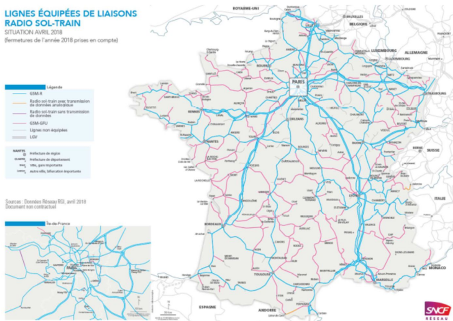
Lignes équipées de liaisons sol-train GSM-R en 2018 (en bleu) – Source SNCF Réseau
